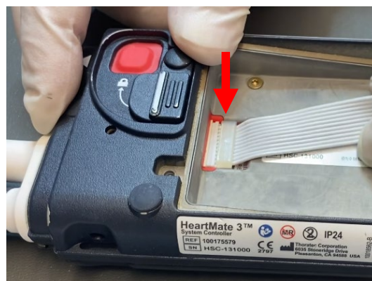
Figura 1: Conexão do Cabo Flat da Bateria de Backup
