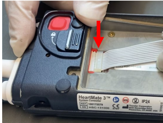
그림 1: 백업 배터리 리본케이블 연결지점
