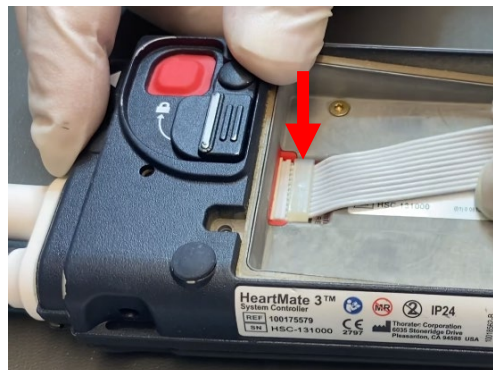
Figure 1 : Connexion du câble plat de la batterie de secours
