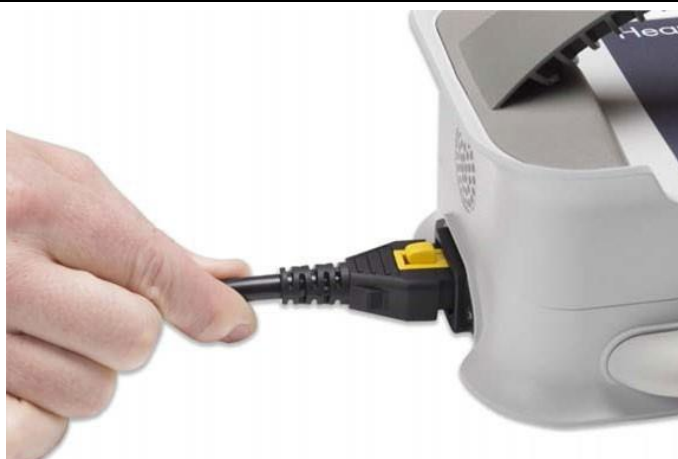
図 44 安全に接続されていることを軽く引いてみて確認する
