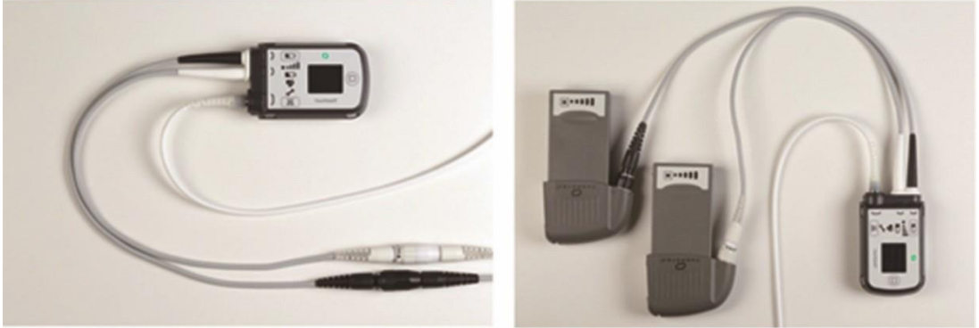
図 22 運転モードのシステムコントローラ（左はモバイル電源ユニット、右は 14V リチウムイオンバッテリーに接続）
