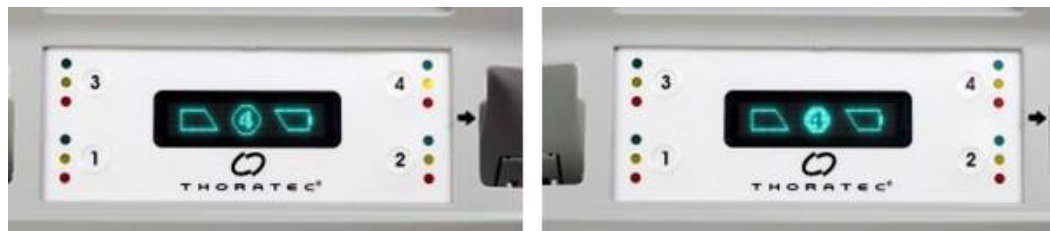
図 79 充電ポケットの 4 番のバッテリーにキャリブレーションが必要なときの表示
