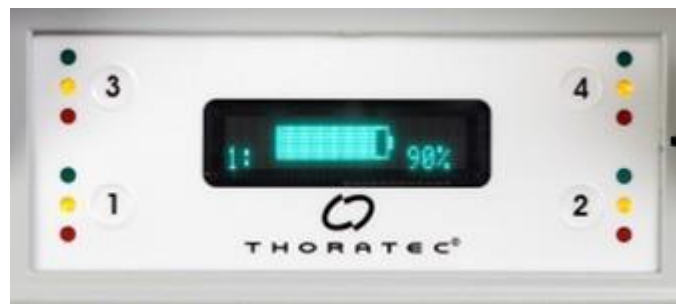
図 77 バッテリーチャージャでバッテリーの充電レベル情報を確認する
