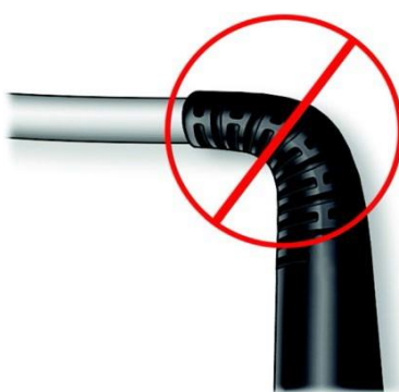
図 16 電源ケーブルは鋭角に曲げないこと
