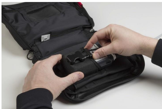
図 116 ストラップをケーブルの間を通してシステムコントローラの上に伸ばし、クリップで留める
