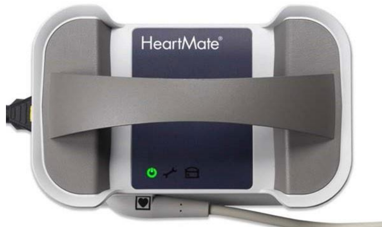
図 143 モバイル電源ユニットのランプ
