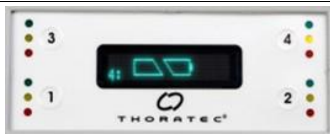
図 80 キャリブレーション実行中のポケット 4 のバッテリー
