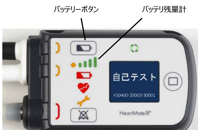
図 20 満充電を示しているバッテリー残量計
