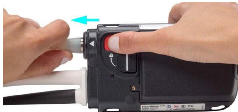
図 31 ドライブライン端部を掴んでドライブラインを取り外す
