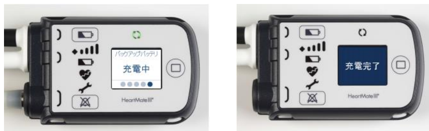
図 27 充電中または充電が完了したシステムコントローラ
