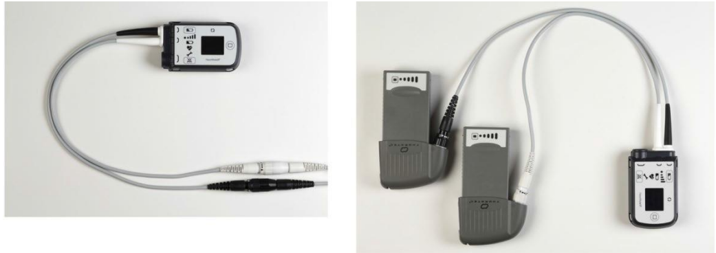
図 24 充電モードのシステムコントローラ（左はモバイル電源ユニット、右は 14V リチウムイオンバッテリーに接続）
