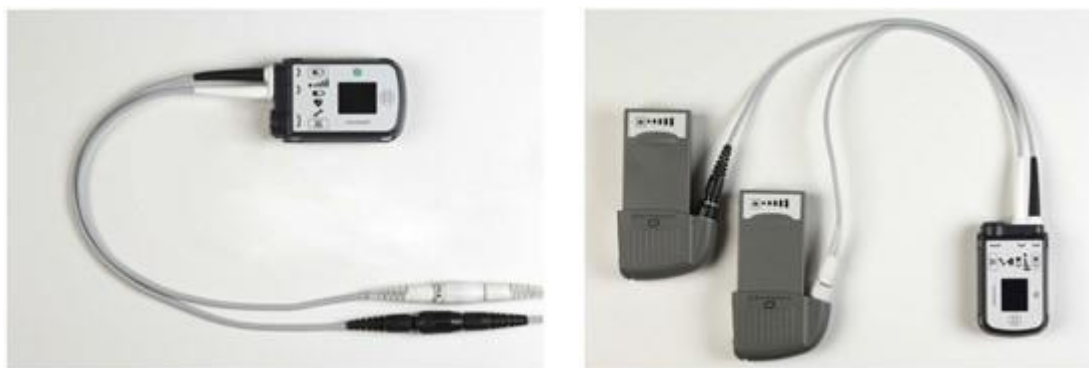
図 26 システムコントローラ。左はモバイル電源ユニットに、右は 14V リチウムイオンバッテリーに接続した状態
