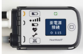
画面 1 – 黒色の電源ケーブル外れ
