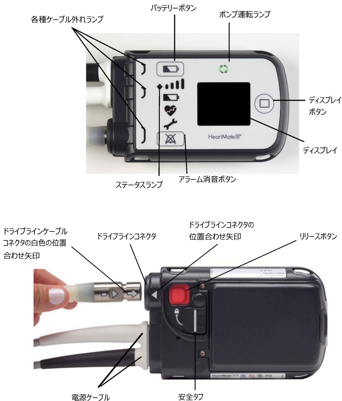
図 6 システムコントローラのユーザーインターフェース（上）と各部名称（下）
