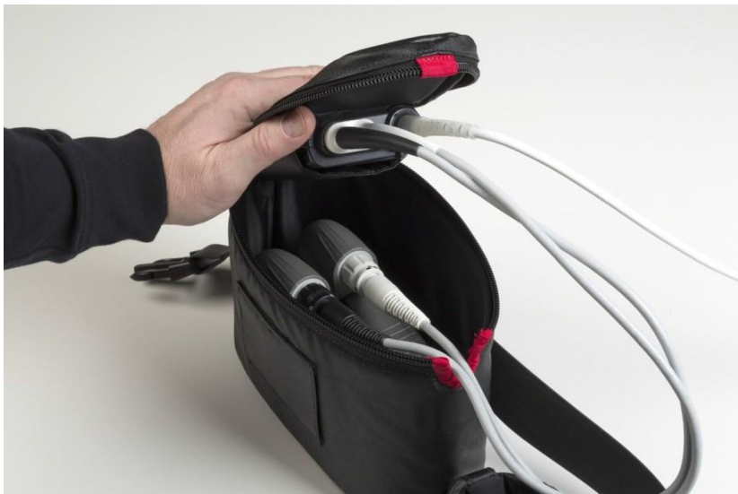
図 92 電源ケーブルを耐水性ケースに慎重に収める
