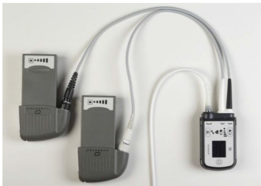
図 88 電源ケーブルとドライブラインがねじれていないことを確認する
