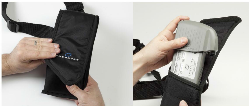
図 130 マジックテープ付きのフラップを開き、バッテリークリップに装着した 14V リチウムイオンバッテリーを挿入する
