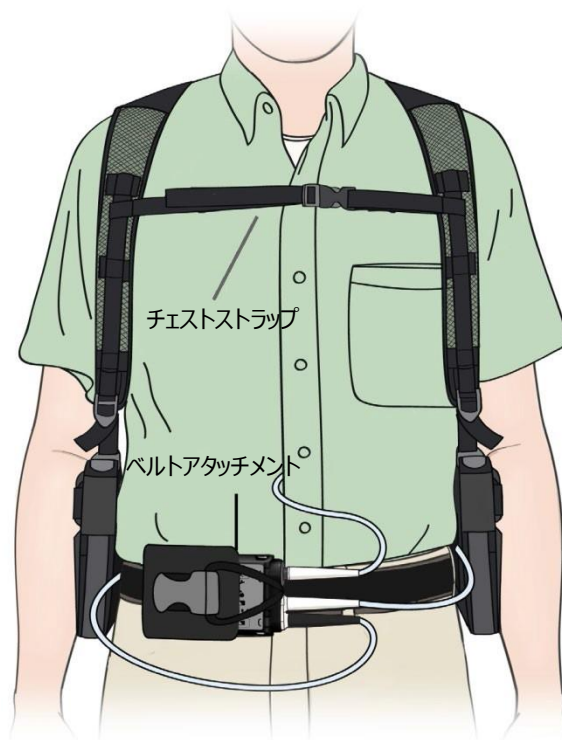
図 133 ベルトアタッチメントとチェストストラップを付けたホルスターベスト
