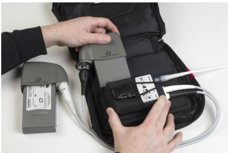
図 117 バッテリークリップに取り付けた 14V リチウムイオンバッテリーをキャリングバッグに収容する
