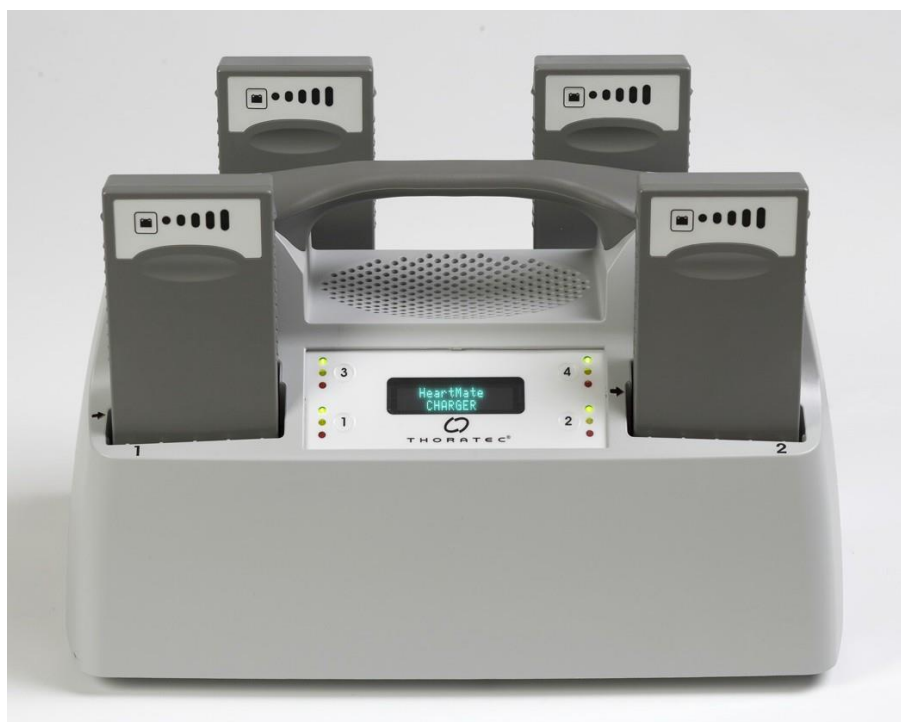
図 76 バッテリーチャージャは一度に 4 つのバッテリーを充電できる
