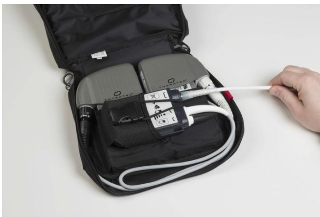
図 121 ドライブラインが赤色の保護用タブの間から出るようにバッグを閉める
