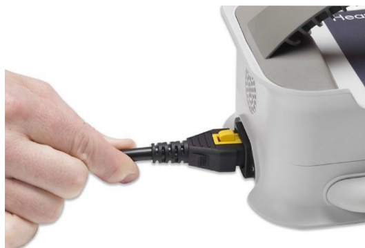
図 3.46 安全に接続されていることを引っ張って確認する
