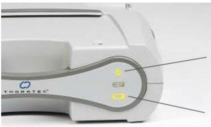
図 3.26 内蔵バッテリー残量が 15 分未満であることを示す、黄色の電源ランプとバッテリーアラームランプ
