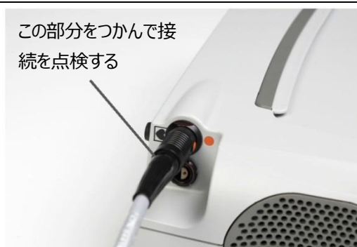
図 3.15 黒色のストレーンリリーフ部分を引っ張って接続をチェックする
