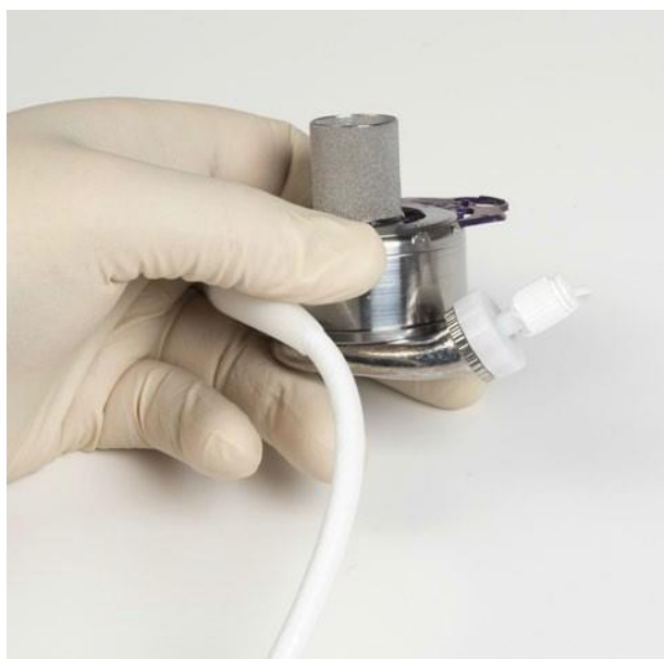
図 5.27 ルアーロックキャップ付きねじプロテクタを血液ポンプ送血側に取り付ける
