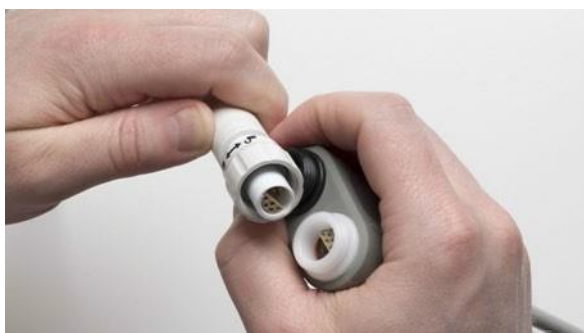
図 7.7 半円型の端子を向かい合わせて位置を合わせる
