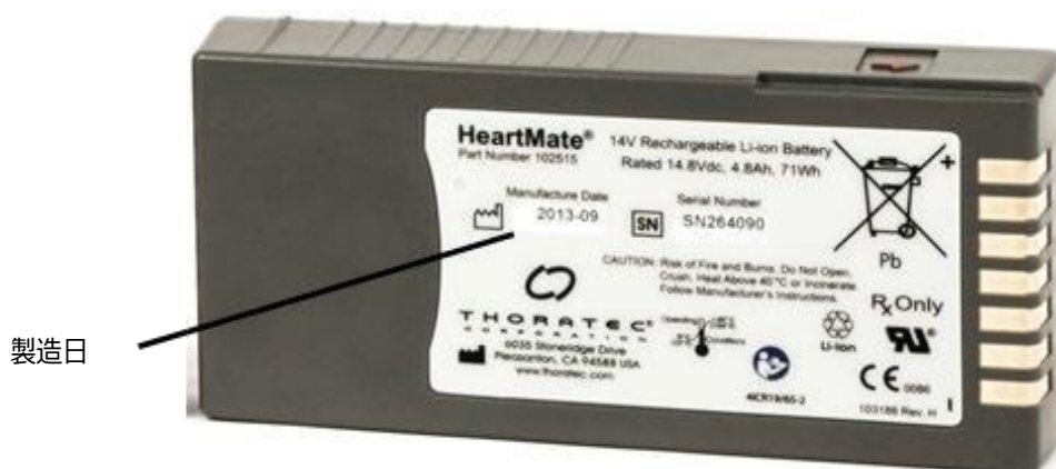
図 F.1 製造日をチェックして、14V リチウムイオンバッテリーの使用期限を確認する
