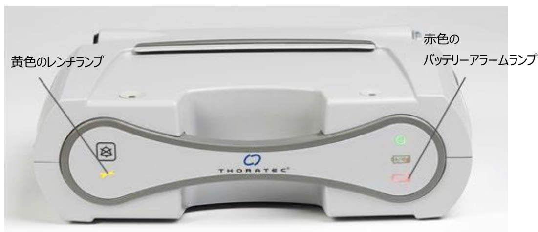
図 3.27 内蔵バッテリーが機能していないため、直ちに別の電源に切り替える必要があることを示す
