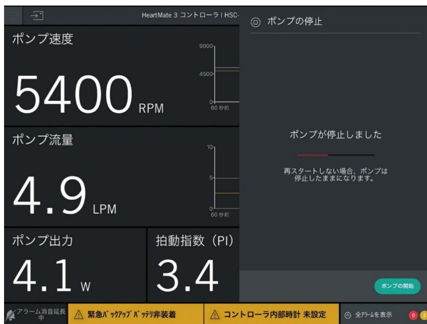
図4.62 ポンプ停止進捗状況バー
