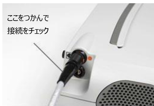
図 3.68 黒色のストレーンリリーフ部分を引っ張って接続をチェックする
