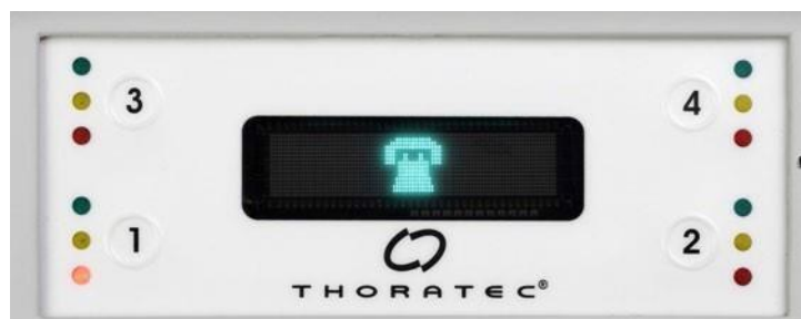
図 7.6 1 番の充電ポケットの故障メッセージ。赤色の充電ランプが点灯。
