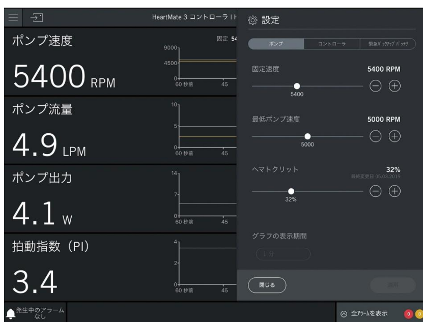
図 4.26 ポンプパラメータが表示されている [Settings (設定)] パネル
