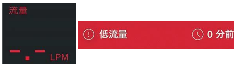
図 4.52 LOW FLOW ( 低流量 ) アラームとポンプ流量
