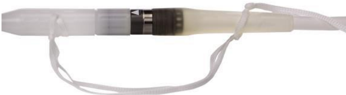
図 5.7 トンネリングアダプタとポンプケーブルコネクタの確実な接続
