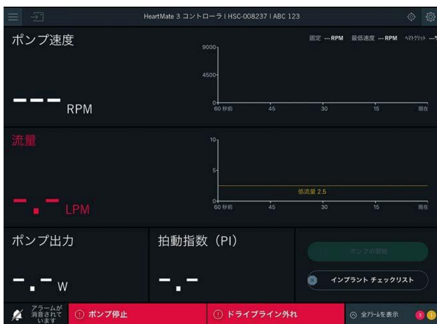
図 4.53 ライブラインが外れたときのアラーム
