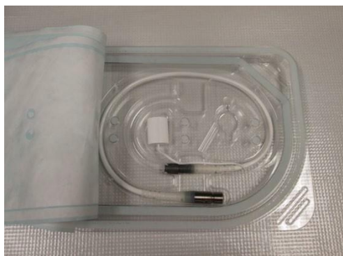
図 5.14 モジュールケーブルの外側と内側のふたをはがした状態のプラスチックトレイ
