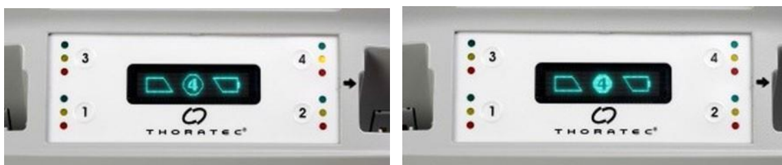
図 3.79 ポケット 4 の 14V リチウムイオンバッテリーにキャリブレーションが必要な場合の誘導メッセージ（グラフィックモード）
