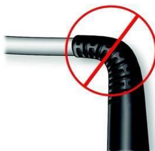
図 6.55 電源ケーブルのストレインリリーフ部分近くの曲がりは特に注意が必要
