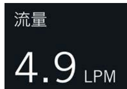
図 4.51 ポンプ流量表示
