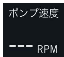
図 4.50 ドライブラインが接続された状態でポンプが停止された
