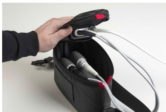
図 6.9 電源ケーブルを耐水性ケースに収容する
