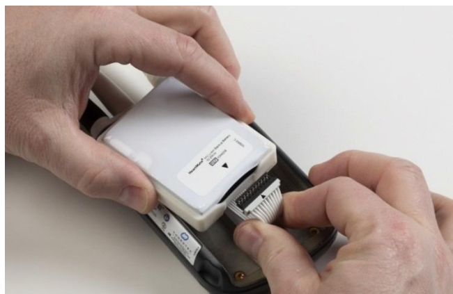
図 2.32 緊急バックアップバッテリーの取り付け
