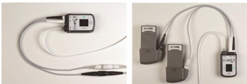
図 2.19 パワーモジュールによる駆動時（左）とバッテリー駆動時（右）の運転モードのシステムコントローラ
