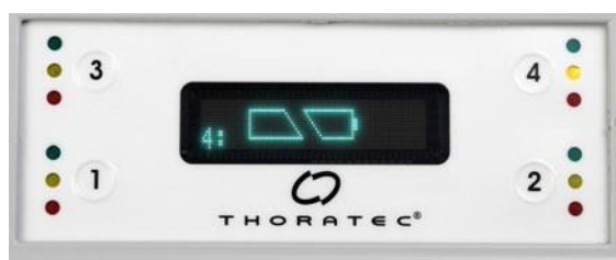
図 3.80 ポケット 4 の 14V リチウムイオンバッテリーがキャリブレーション実行中であることを示す表示
