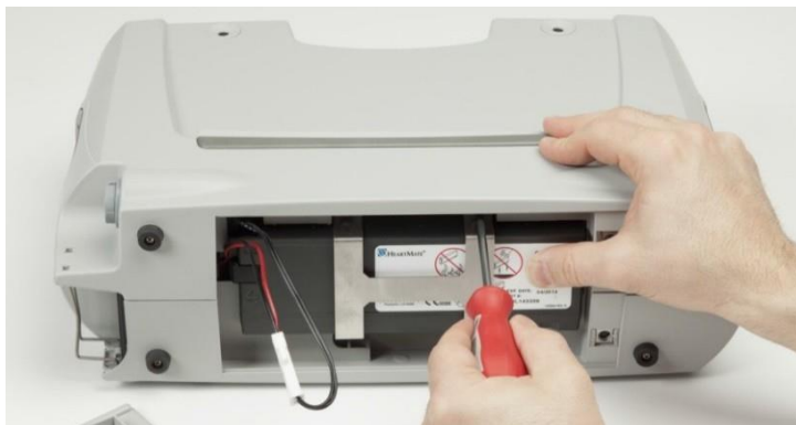
図 3.7 金属ブラケットの再取り付け
