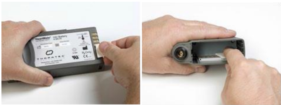
図 8.1 14V リチウムイオンバッテリーとバッテリークリップの接点をきれいにする
