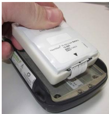
図 5.52 緊急バックアップバッテリーコンパートメントに緊急バックアップバッテリーをセットする
