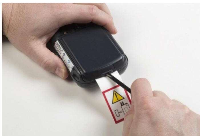
図 2.25 レバーを使用してスクリーカバーを外す
