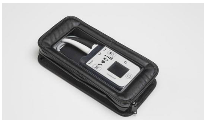
図 6.51 予備用コントローラと電源ケーブルを収容したプロテクションバッグ
