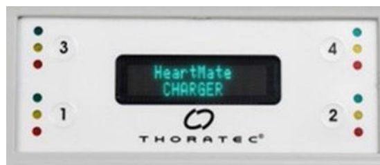
図 3.77 ポケット 1 からポケット 4 の充電状態を示すランプ（緑色、黄色、赤色）
