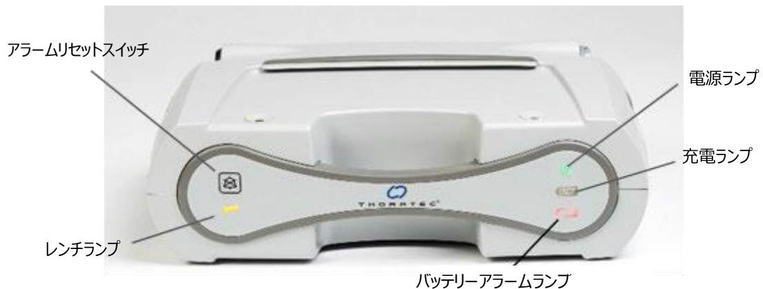
図 7.4 パワーモジュールのランプとスイッチ
