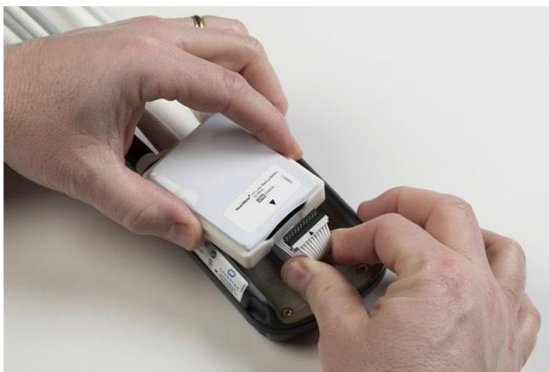
図 5.51 ケーブルの矢印を緊急バックアップバッテリーの矢印に合わせる
