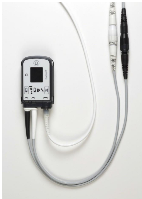
図 3.23 PM ケーブルに接続した駆動用システムコントローラの電源ケーブル
