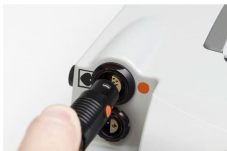
図 3.19 コネクタの赤色の点とパワーモジュールの赤色の点を合わせる
