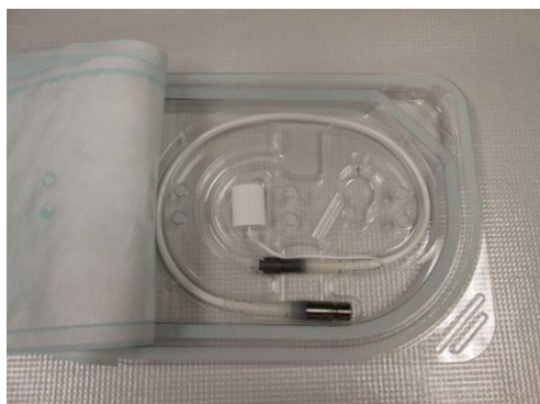
図 5.15 モジュールケーブルの外側と内側のふたをはがした状態のプラスチックトレイ
