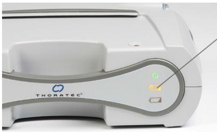
図 3.25 パワーモジュールの内蔵バッテリーが充電中であることを示す黄色の充電ランプ
