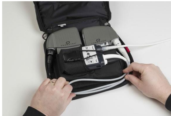
図 6.36 キャリングバッグにセットした 14V リチウムイオンバッテリーと電源ケーブル
