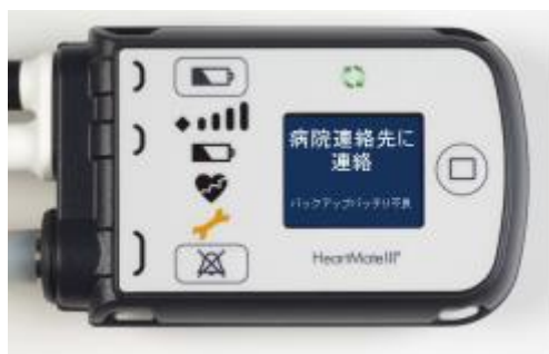
図 2.23 緊急バックアップバッテリーの故障アラーム
