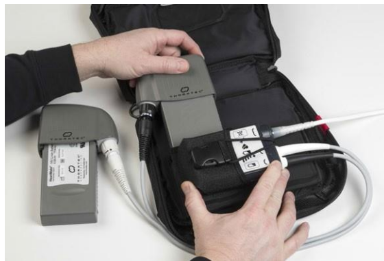
図 6.33 1 つ目の 14V リチウムイオンバッテリーをバッグに配置する
