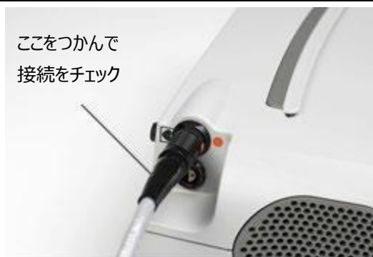
図 3.68 黒色のストreinリリース部分を引っ張って接続をチェックする
