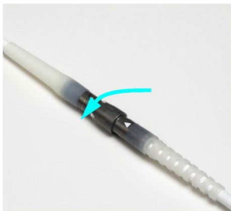
図 2.48 ポンプケーブル接続コネクタのロックナットを回転させる
