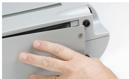
図 3.35 バッテリーコンパートメントのカバーを外す
