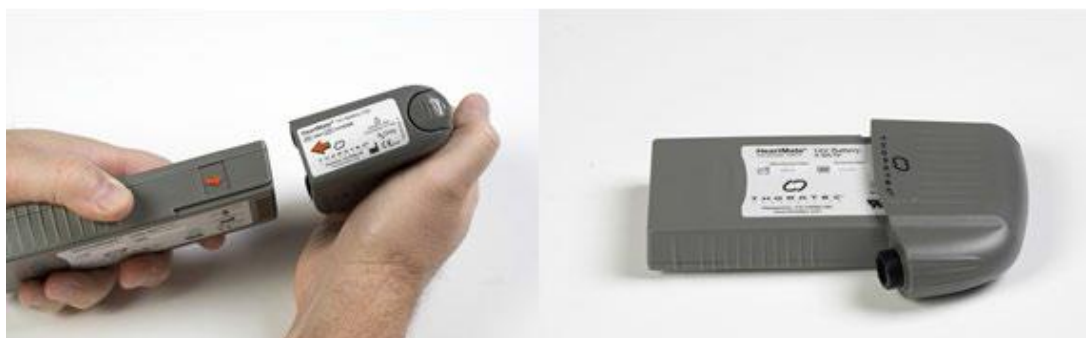
図 3.57 14V リチウムイオンバッテリーをバッテリークリップに挿入する
