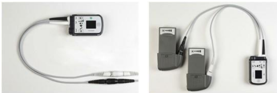
図 2.34 パワーモジュール（左）と 14V リチウムイオンバッテリー（右）に接続したシステムコントローラ
