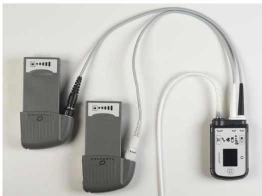
図 6.5 システムコントローラの電源ケーブルとドライブラインがねじれていないことを確認する
