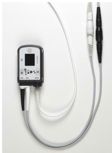
図 6.40 電源ケーブルとドライブラインがねじれていないことを確認する
