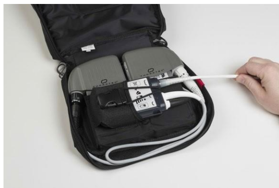
図 6.37 ドライブラインが赤色の保護用タブの間から出るようにバッグを閉める
