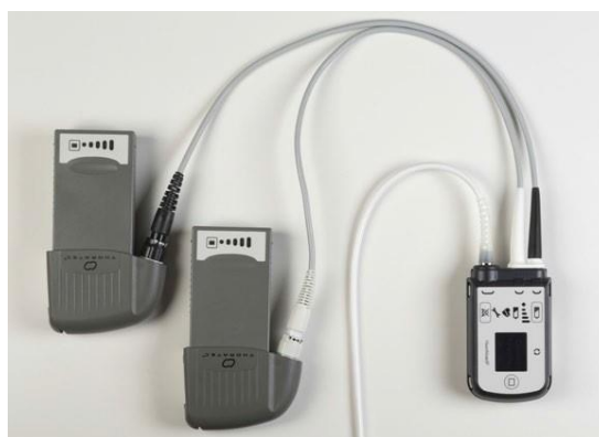
図 3.63 バッテリークリップに接続したシステムコントローラの電源ケーブル
