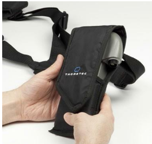
図 6.43 ホルスタに収容し、フラップを閉じた 14V リチウムイオンバッテリー
