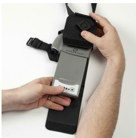
図 6.47 14V リチウムイオンバッテリーとバッテリークリップをホルスタに挿入する
