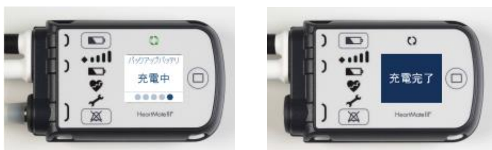
図 2.35 充電中または充電が完了したシステムコントローラ
