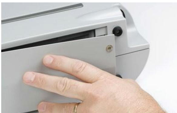
図 3.29 バッテリーコンパートメントのカバーを外す
