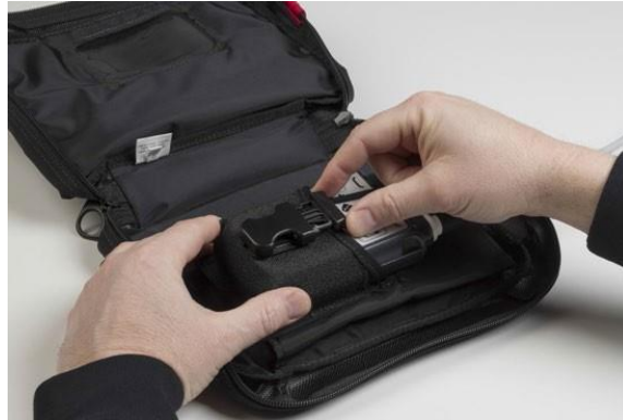
図 6.32 ストラップを用いてシステムコントローラを固定する
