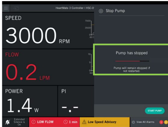
Figure 2 : Affichage de la barre de progression rouge et noir « STOP PUMP » [ARRÊT DE LA POMPE], indiquant que la séquence est EN COURS . Ne pas déconnecter le contrôleur du système ou l'adaptateur sans fil.
